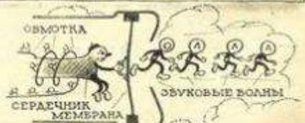
3. Микрофонная трубка состоит из микрофона и телефонной трубки. Когда говорят перед микрофоном, то под действием звуковых волн начинает колебаться мембрана. При этом она сжимает находящийся под ней угольный порошок. От большей или меньшей степени сжатия угольного порошка зависит его электрическое сопротивление, а вследствие этого — сила тока в электрической цепи.
