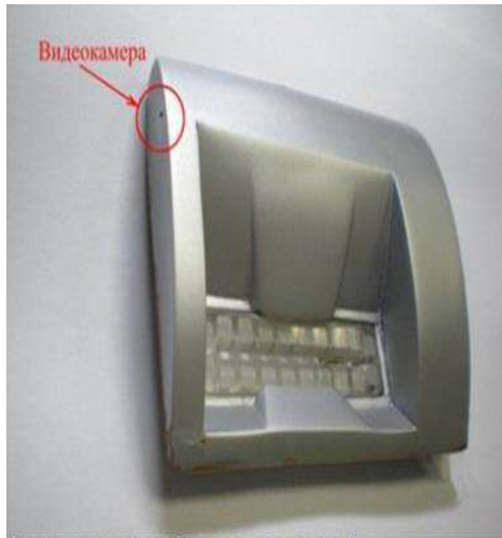
Скимминговое устройство с видеокамерой
