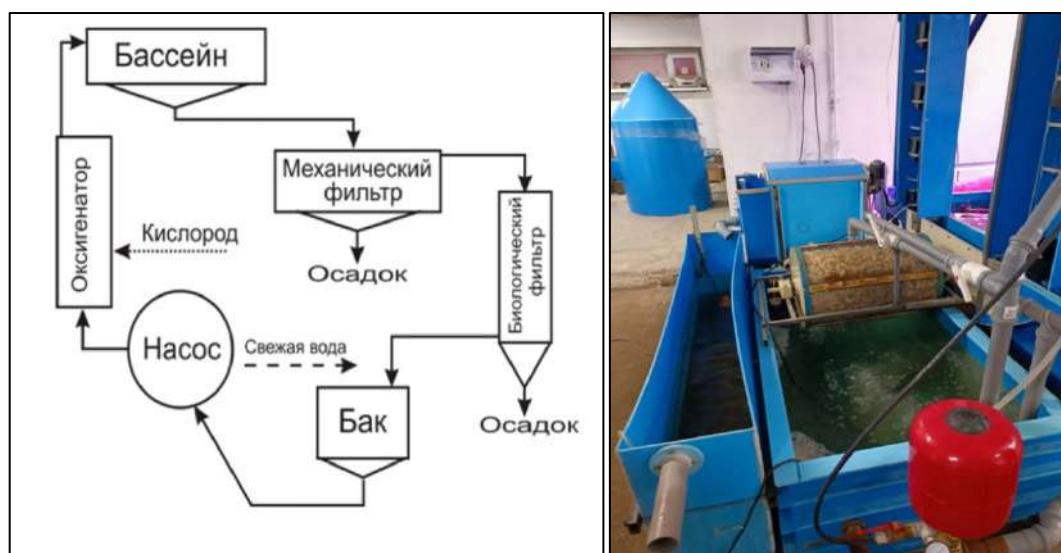
Рис. 10. Схема установки с замкнутым циклом водоснабжения (а), установка с замкнутым циклом водоснабжения для содержания осетров (б)
