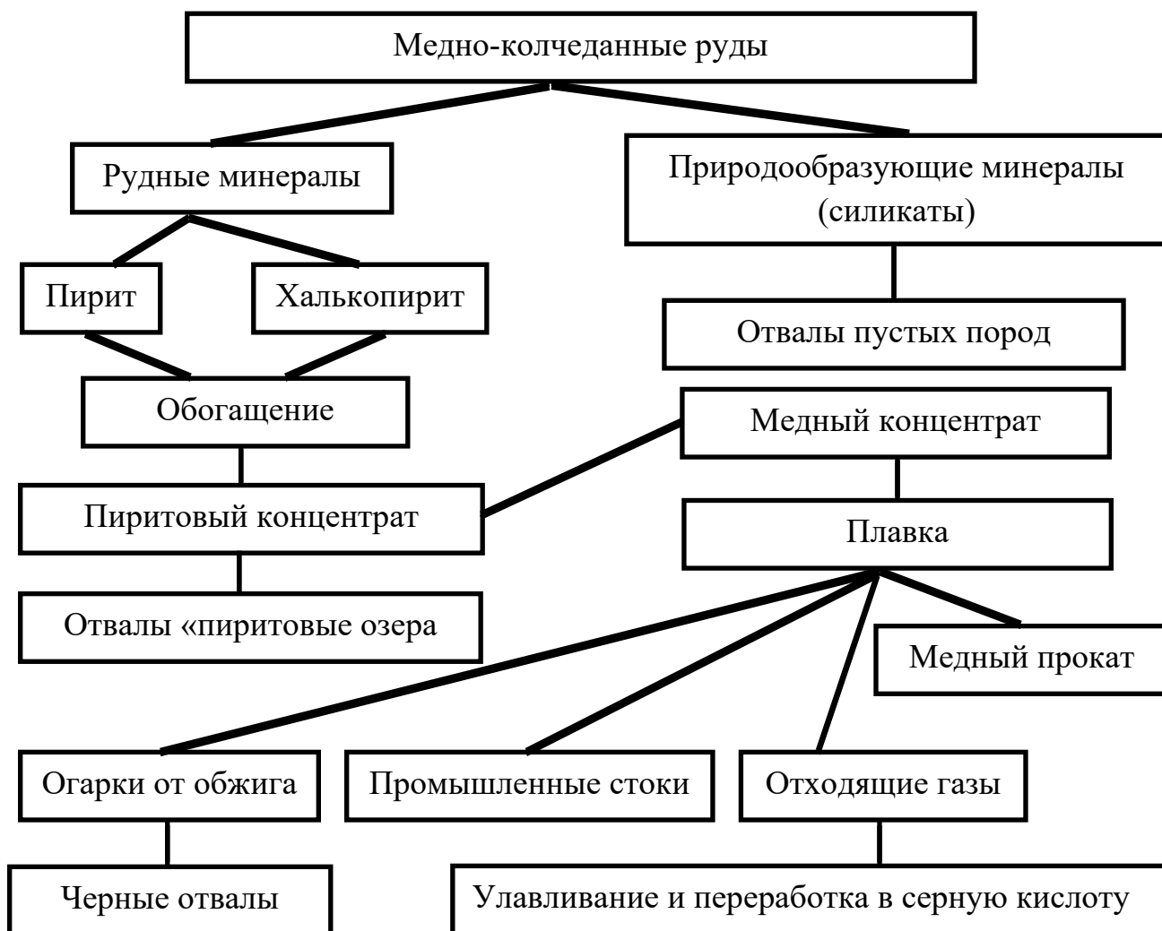
Рис. 4. Схема переработки медно-колчеданных руд на предприятии «Карабашмедь»
