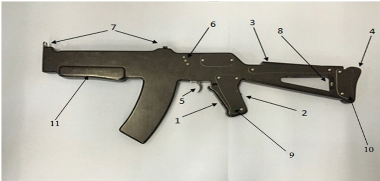
Рис. 1. Тренажёр «ПРИКЛАД»: 1 – пистолетная рукоятка с упруго-подвижной планкой; 2 – контактный выключатель электронного устройства индикации; 3 – планка усилия нажима щеки на приклад; 4 – планка усилия нажатия в плечо; 5 – спусковой крючок; 6 – трехцветный индикатор; 7 – прицельные приспособления; 8 – винт регулировки фиксатора усилия, оказываемого щекой стрелка на гребень приклада; 9 – винт регулировки фиксатора усилия, оказываемого на планку пистолетной рукоятки; 10 – винт регулировки фиксатора усилия, оказываемого прикладом на плечо стрелка; 11 – цевье
